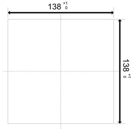
图 6 仪表盘装开孔尺寸，单位 mm
