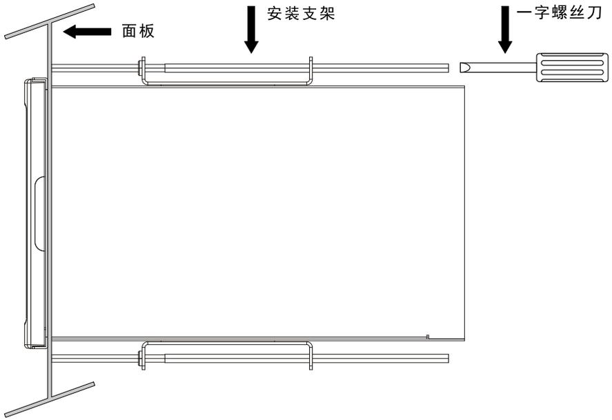
图 4 安装示意图
