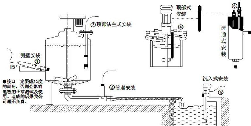
图 2 常见电极安装方式示意图
