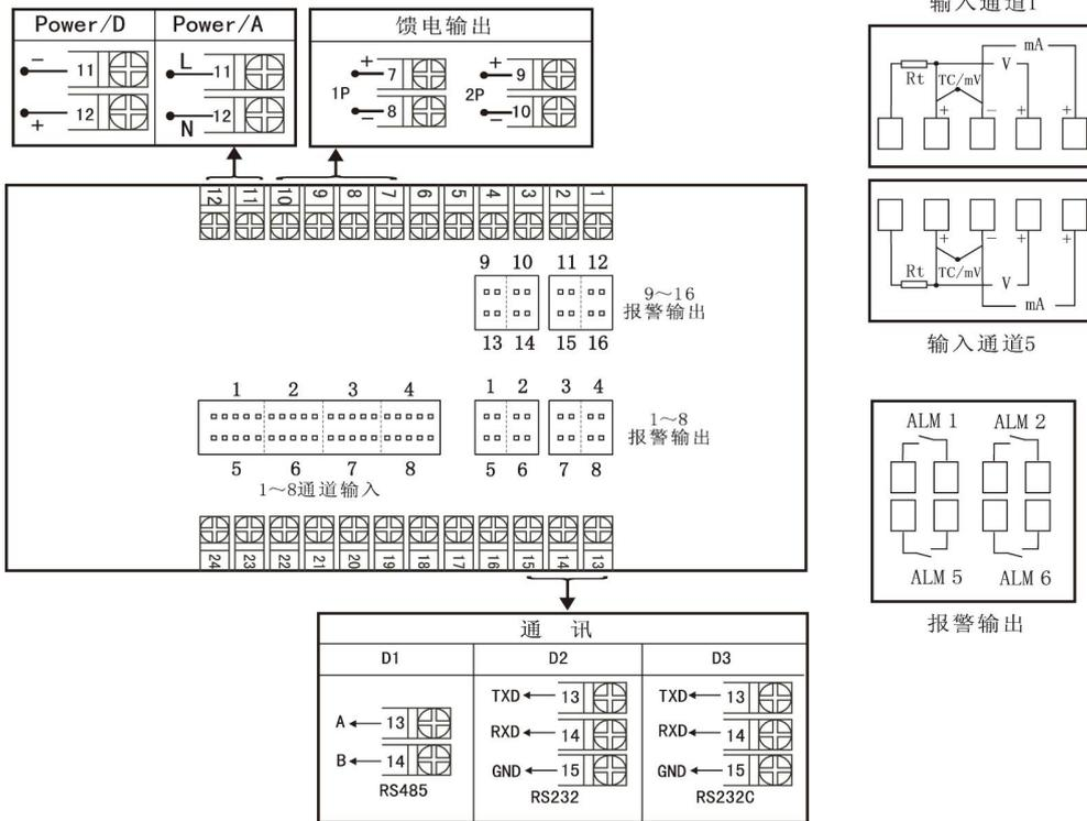
图 4 A、B 型分别报警接线图
