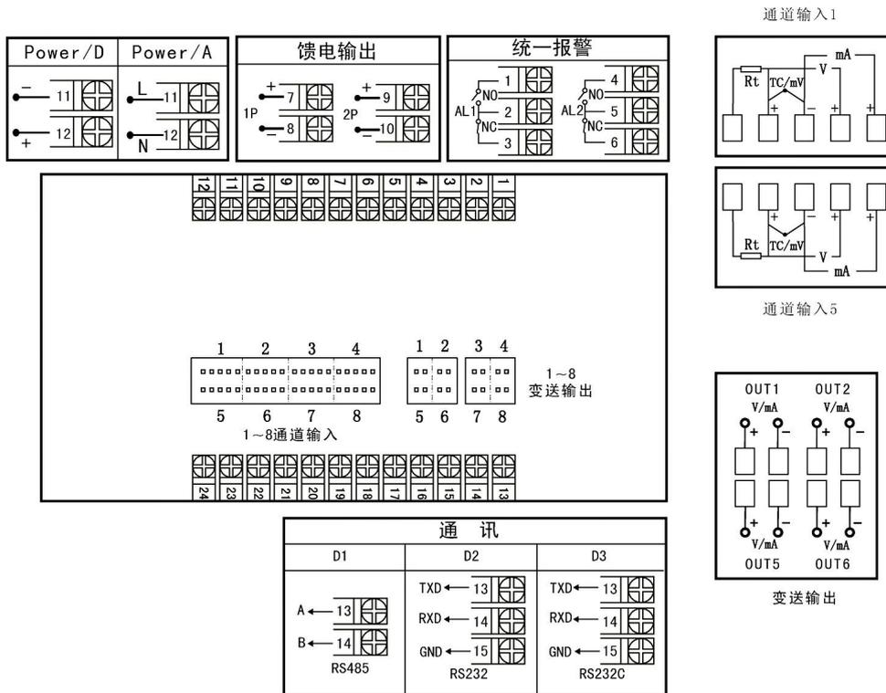
图 5 A、B 型分别变送接线图
