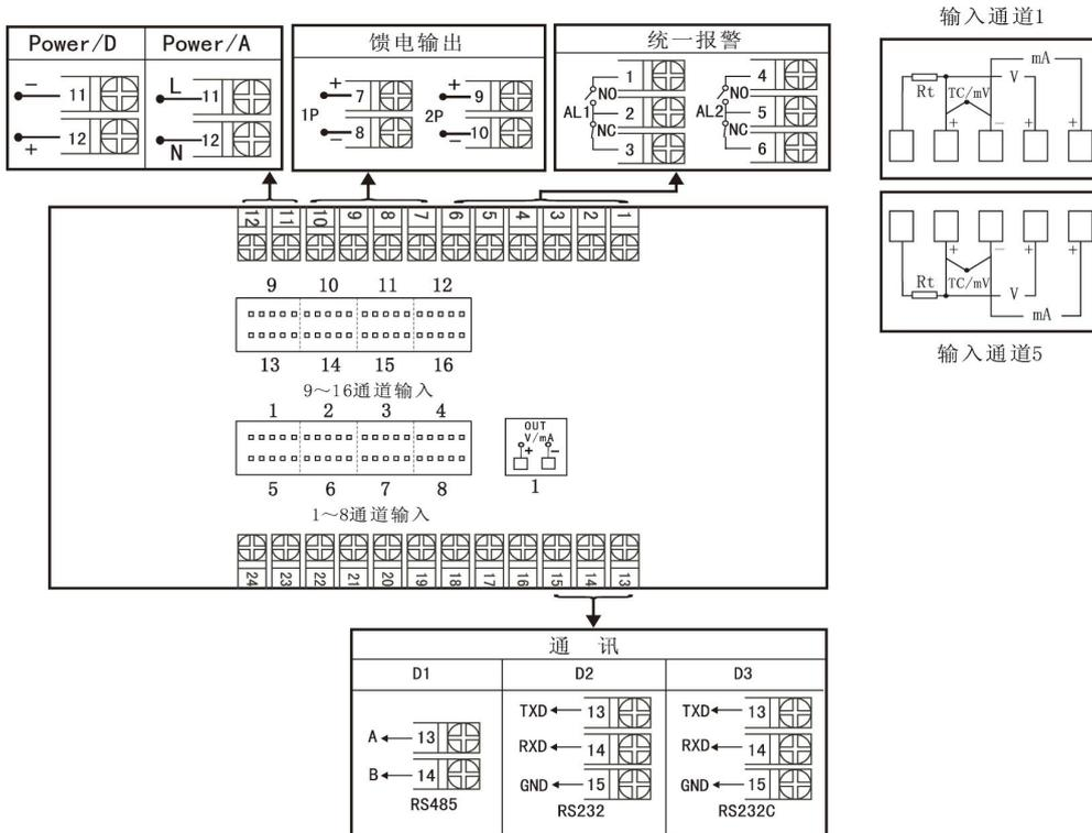
图 3 A、B 型统一变送接线图
