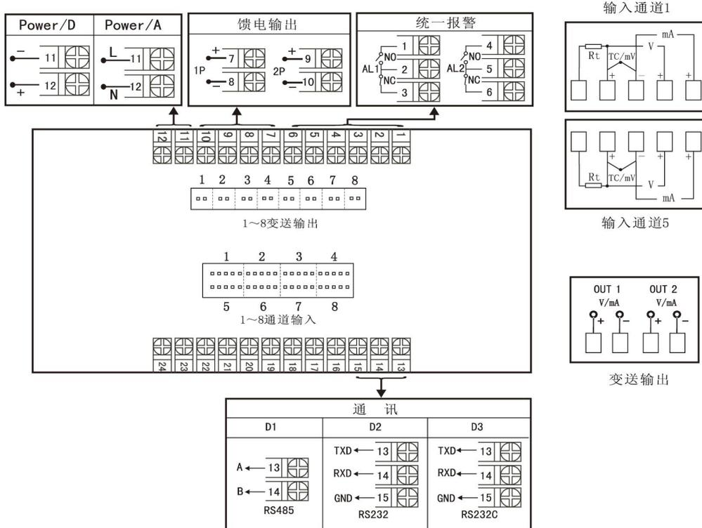
图 7 C 型分别变送接线图
