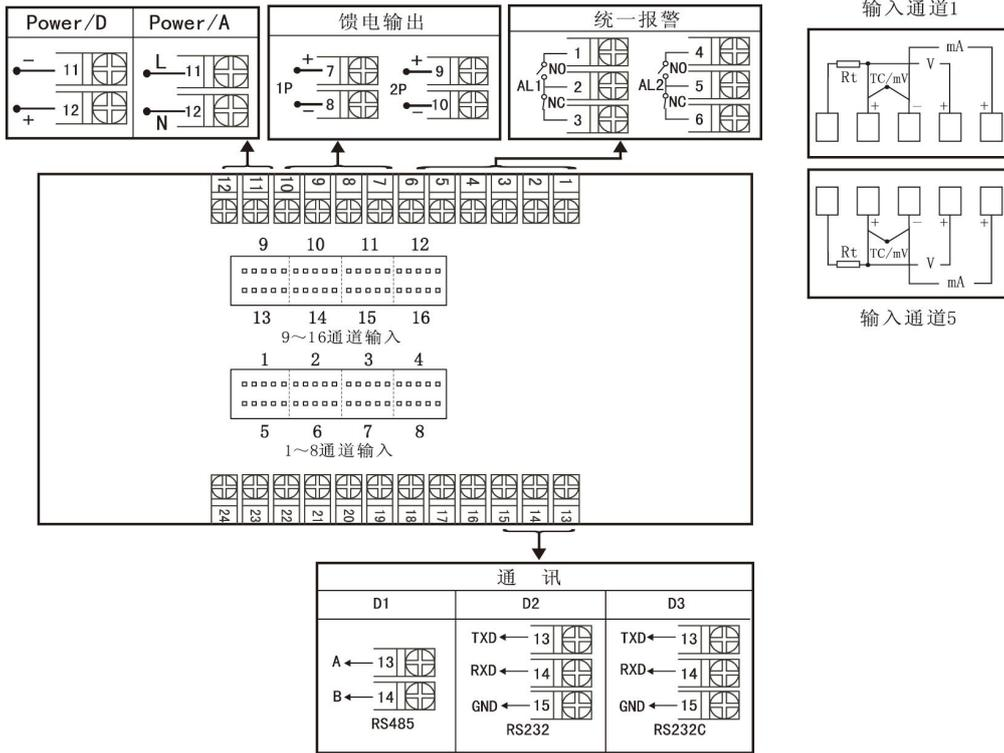
图 2 A、B、C 型统一报警接线图
