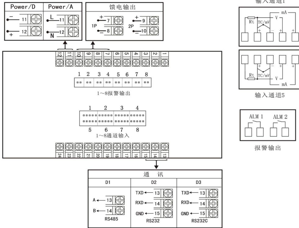
图 6 C 型分别报警接线图
